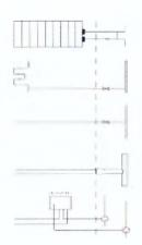
**Отопление** до отсекающей арматуры (первого вентиля) от стояковых трубопроводов, расположенных в общем коридоре в нище  $\ast$
